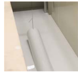
Tauchbad Grundierung: Hohlraumschutz, verwinkelte Teile, kein Verzug
